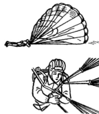
Рис. 6. Гашение купола методом подтягивания нижних строп
